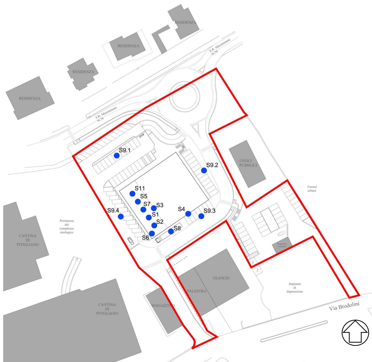
FIGURA 3. PLANIMETRIA DELL'AREA DI INTERVENTO CON LA LOCALIZZAZIONE DELLE SORGENTI DI RUMORE
